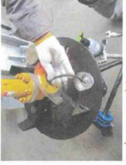
รูปที่ 5 การทดสอบการรั่วซึม / SEAT LEAKAGE TEST
