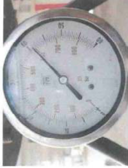
รูปที่ 4 การทดสอบการรั่วซึม / POP TEST
