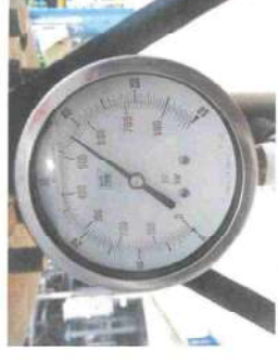
รูปที่ 4 การทดสอบการระบาย / POP TEST
